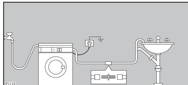
Для обеспечения правильной работы машины сливной шланг должен быть всегда подведен за соответствующий кронштейн, расположенный в верхней части задней панели машины.
